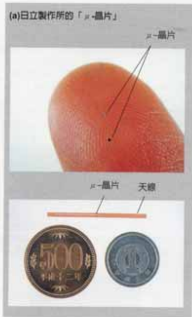
圖2●「粉末」般大小的RFID用晶片登場
